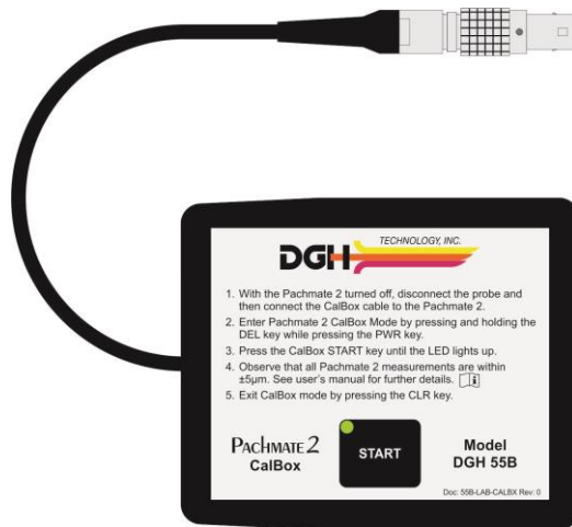
Fig 6.4.1 Modulo elettronico CalBox dell'unità DGH 55B (Pachmate 2)
